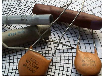
(6) Spannungsfeste Fertig-Kondensatoren
