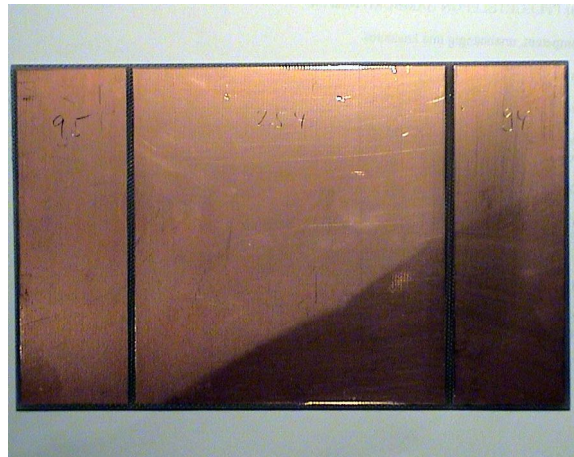
3 Kondensatoren, 95, 254 und 94pf auf einer Eurokarte
