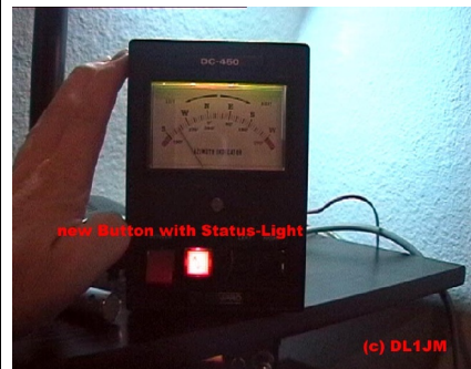
Eine zusätzliche beleuchtete Taste zeigt die Datenkommunikation an und ermöglicht verschiedene Modi (Terminal-Mode, autom. PC-Steuerung und Soft-update)
