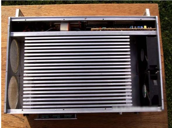
Der selbstgebaute Kühlkörper im Gehäuse der PA
