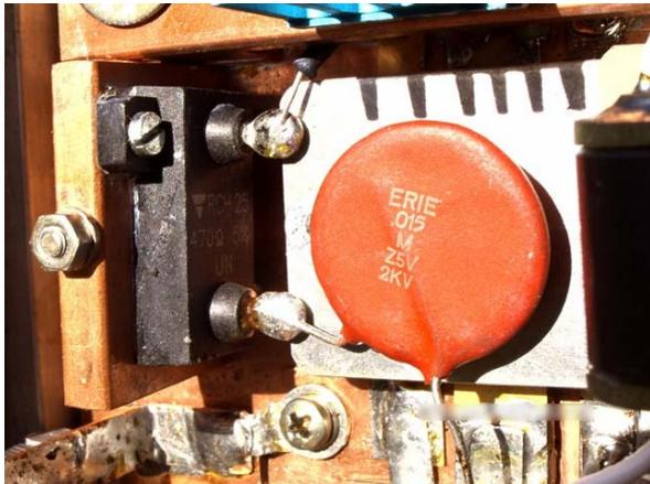
Gegenkopplung je Transistor, Dickfilmwiderstand plus C
