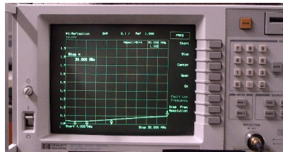
Das alte "Rein-Raus-Messgerät": Reflexions- und SWR-Messung am selbstgebauten 50 Ohm-Hochlast-Dummy
