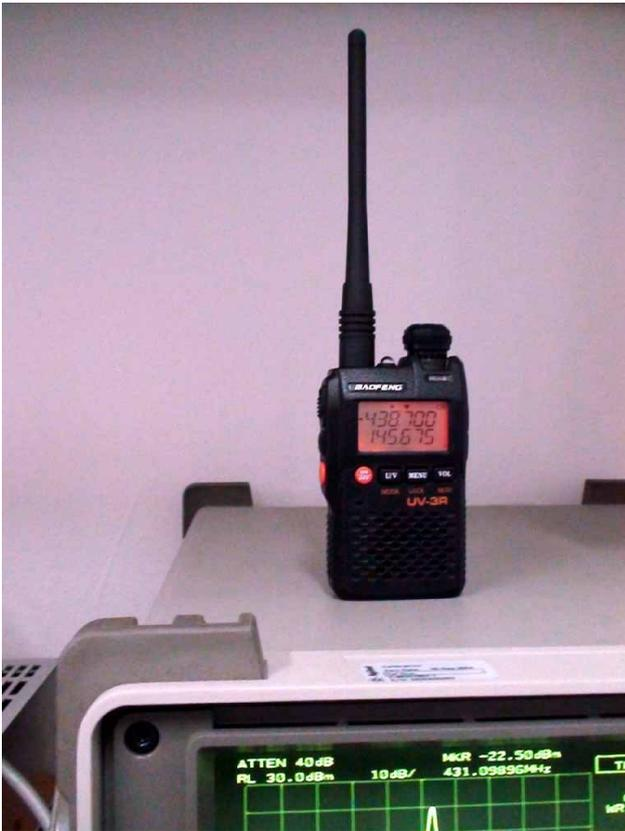
Im 70cm-Band (bei 1,7W Output) werden immerhin -57dB (1.Oberwelle) bei meinem Gerät erreicht - Also ein durchaus noch "akzeptabler" Wert!
