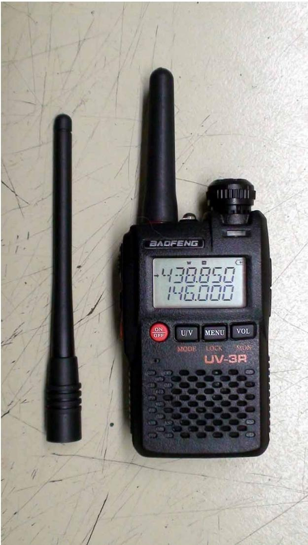
Links die mitgelieferte Duo-Antenne, rechts am Gerät eine eigene 70cm-Gummiwendel.
