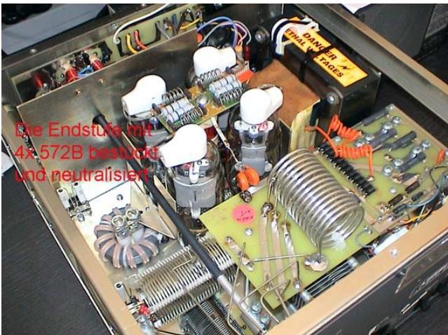
Nicht unerwähnt sollte allerdings bleiben, dass die Endstufe mit den neuen Röhren unbedingt neu-neutralisiert werden sollte. Ein Indiz hierfür ist bereits Schwingneigung im STBY nahe den optimalen Load/Plate-Einstellungen – auch gut sichtbar durch leicht-negative Ausschläge des Gitterstromanzeigeinstruments. Große Vorsicht bei stärkeren Ausschlägen! Dies deutet auf starke Oszillation oder sehr fehlerhafte Neutralisation hin (es können sogar interne Schäden oder Defekte dabei entstehen!).
