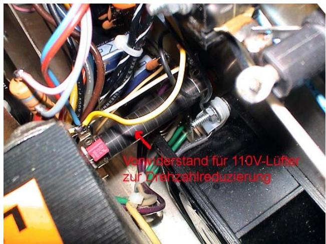
Über ein zusätzliches Relais wird im Sendebetrieb (PTT) und bei hoher Innentemperatur (über Thermoschalter) die Drehzahl wieder erhöht - durch Überbrückung des Vorwiderstandes.
