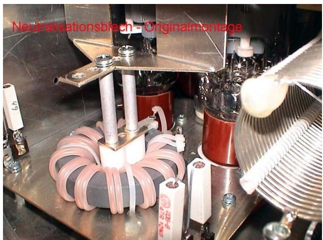
Zur Neutralisation sind der Ringkerntrafo und das verstellbare Blech (=Koppel-C zu den Anoden) zuständig. Großer Abstand = schwache Neutralisation. Never ever oder nie-niemals im laufenden Betrieb dran rum-schrauben. Hand ab! Es beißt u.U.
