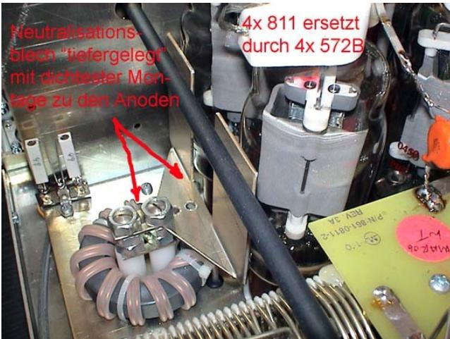
L1 für 10m nicht optimal einstellen lässt (Spulenkerne ganz herausgedreht und schlechtes SWR zum Transceiver) muss ggf. auch noch den Eingangskreis um eine Windung reduzieren (siehe Bild).
