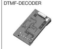
Ermöglicht Funkruf- und Codesquelch-Betriebsmöglichkeit.
