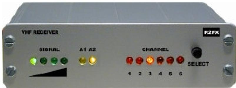
Der R2FX ist ein FM-Empfänger, der speziell für den Empfang der umlaufenden Wetter-satelliten im 2m-Band entwickelt wurde. Er besitzt sechs Kanäle, die über einen Taster auf der Frontplatte abgerufen werden können. Eine Steuerung des Gerätes ist auch über die eingebaute serielle Schnittstelle möglich. Die Kanäle sind mit den derzeit benutzten Satellitenfrequenzen vorbelegt, können aber über die serielle Schnittstelle umprogrammiert werden.
